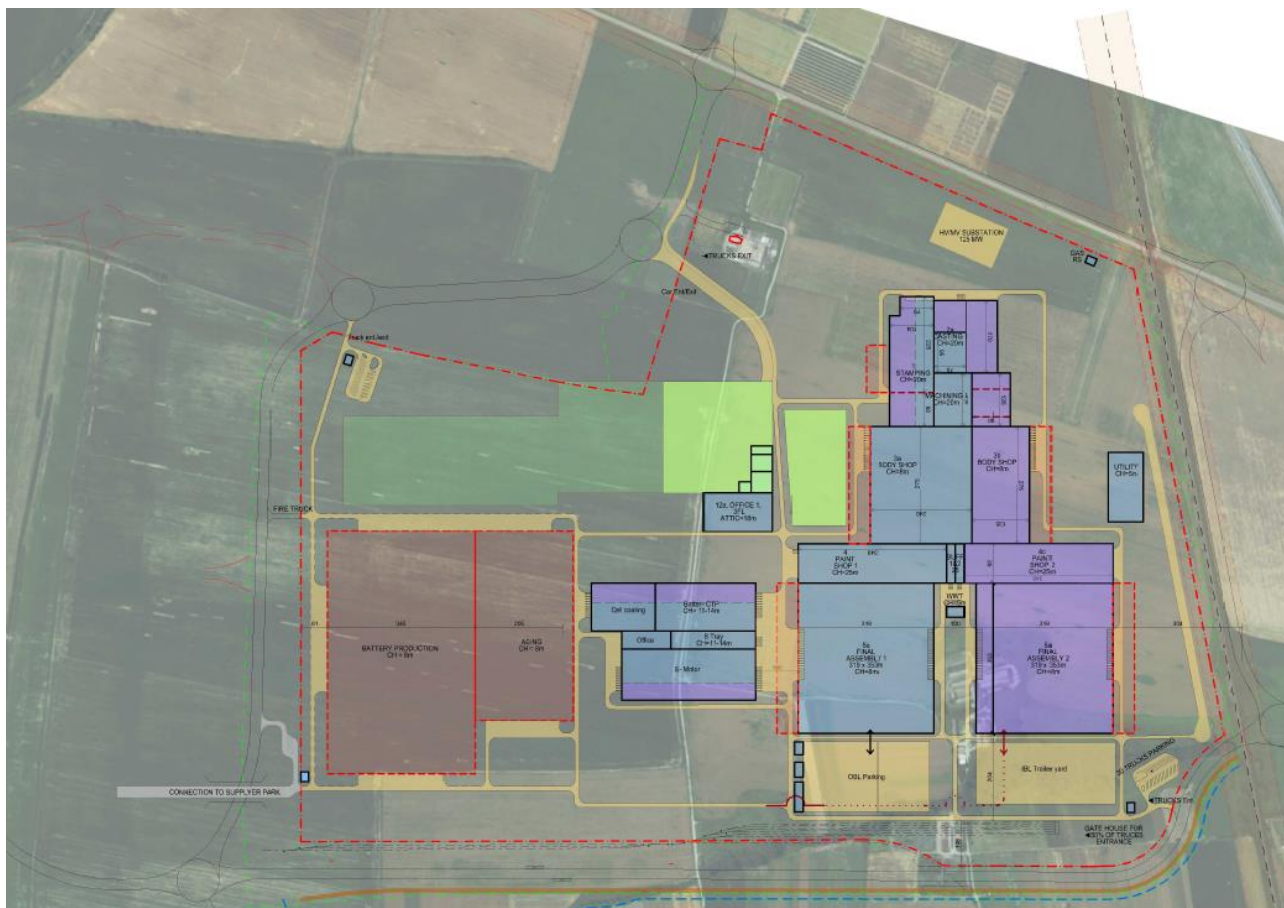
Obr.5 Plánované rozmiestnenie hlavných objektov v závode na výrobu automobilov –Variant 4
