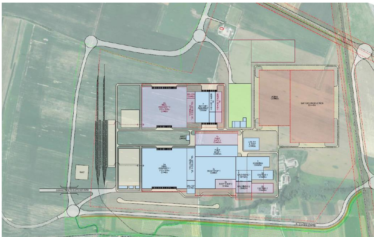
Obr.2 Plánované rozmiestnenie hlavných objektov v závode na výrobu automobilov – Variant 1
