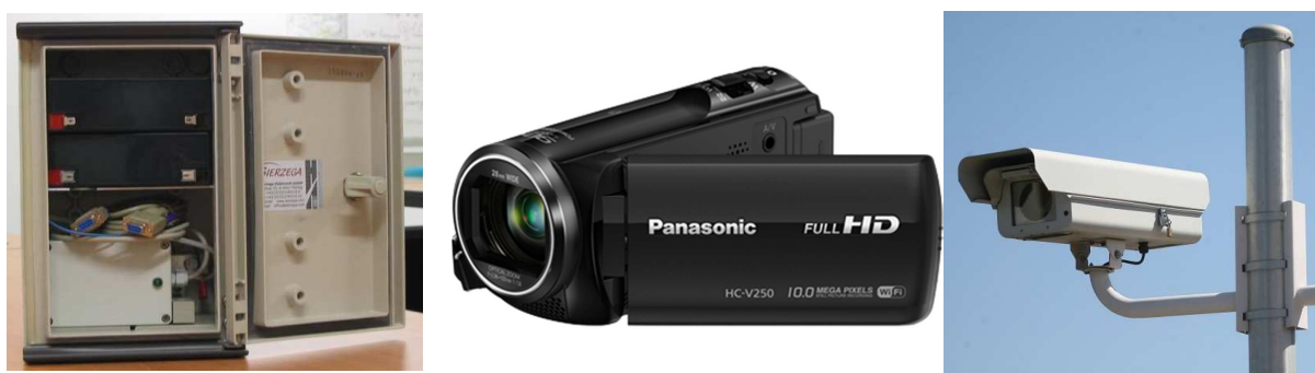
Obrázok 64 Typológia záznamových zariadení použitých v rámci dopravného prieskumu: automatické sčítacie zariadenie (vľavo), videokamera (v strede) a ANPR kamera (vpravo)
